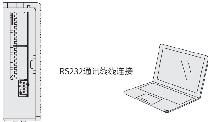
图 5-1 驱动器调试端子连接示意图
