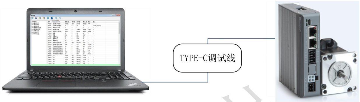
图 4-2 驱动器与 PC 的连接示意图
