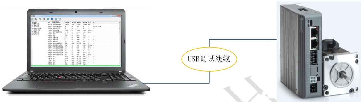
图 4-2 驱动器与 PC 的连接示意图
